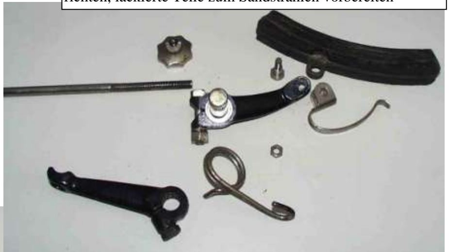
Explosionsfoto der Hinterradbremse. Teile für Vernickler richten, lackierte Teile zum Sandstrahlen vorbereiten
