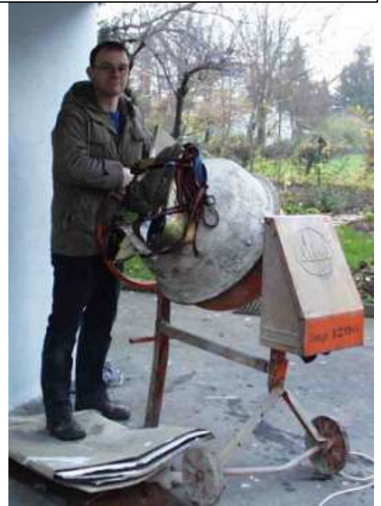
November 2000 Tank innen schleifen: (Gleitschleifverfahren): Tank wird mit kleinen Trovalisier-Steinen gefüllt auf der Betonmischmaschine festgezurt und unter Zugabe von Waschmittel mehrere Stunden lang in allen möglichen Positionen innen ausgeschliffen. (Achtung Betonmaschine kann kippen/ umfallen)
