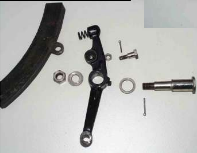
Weitere zu restaurierende Teile: Fußraster für Sozius => hier Originalzustand im Januar 2001 (manche nennen das auch Schrott) Arbeiten: alles zerlegen, in Funktion bringen, sandstrahlen, Achsen neu drehen, Nieten drehen, lackieren, neue Gummis besorgen, Halter erneuern, zusammenbauen
