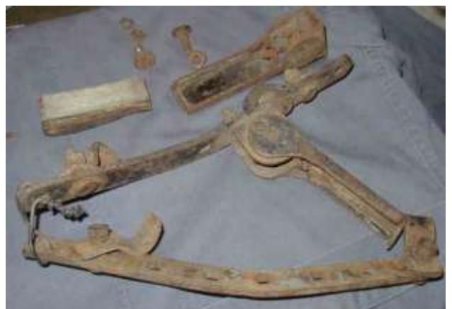
Vorderradbremse vormontieren, Bremsbelag von Bremsenband anpassen (Holz als Bremsklotz zu verwenden halte ich nicht mehr für zeitgemäß), Bremsbelagnieten aus Cu drehen, ausglühen, montieren, Achse für Bremshebel neu drehen
