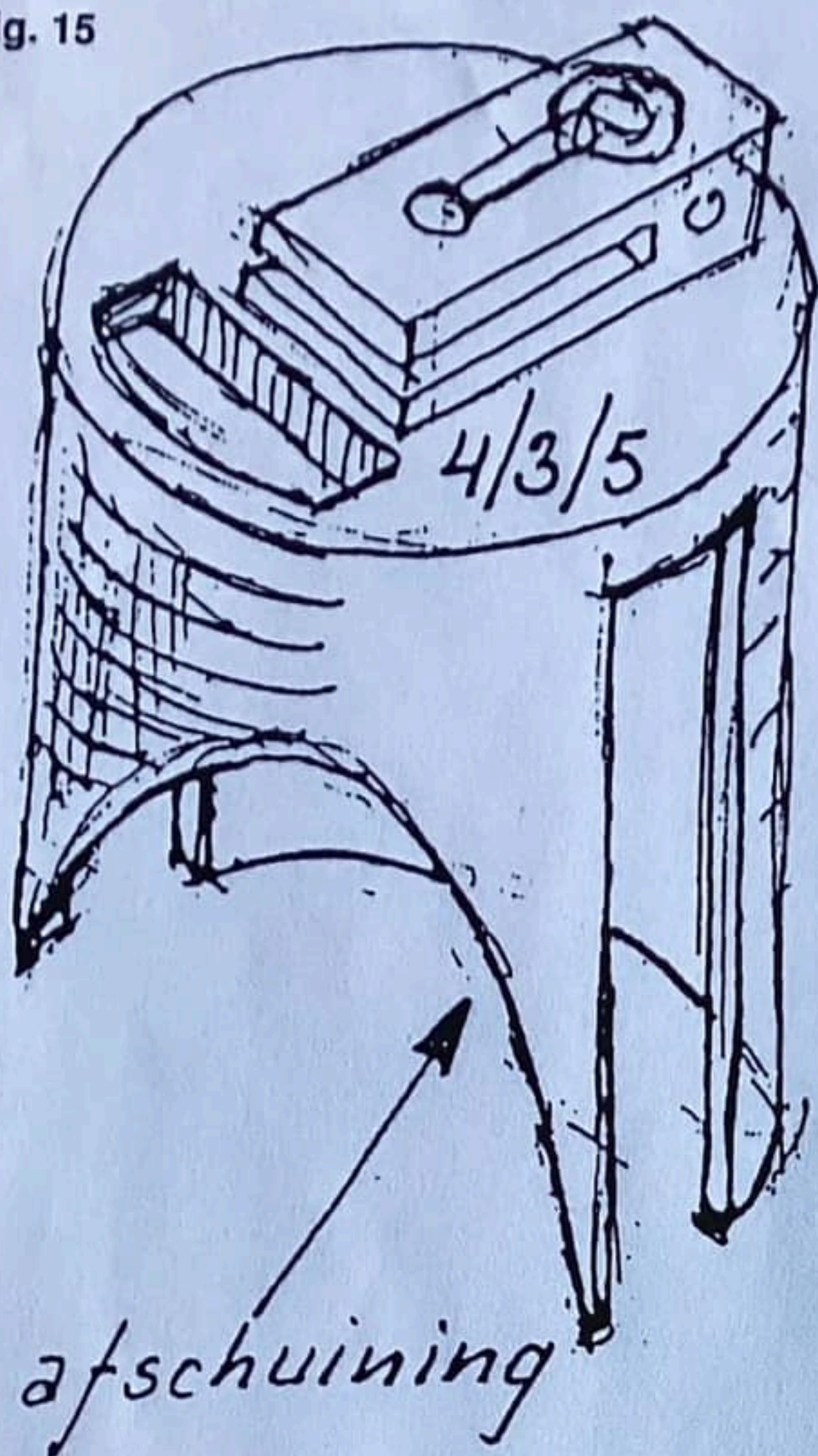
De sproeiernaald met de gasschuif in de stand van fig. 16
