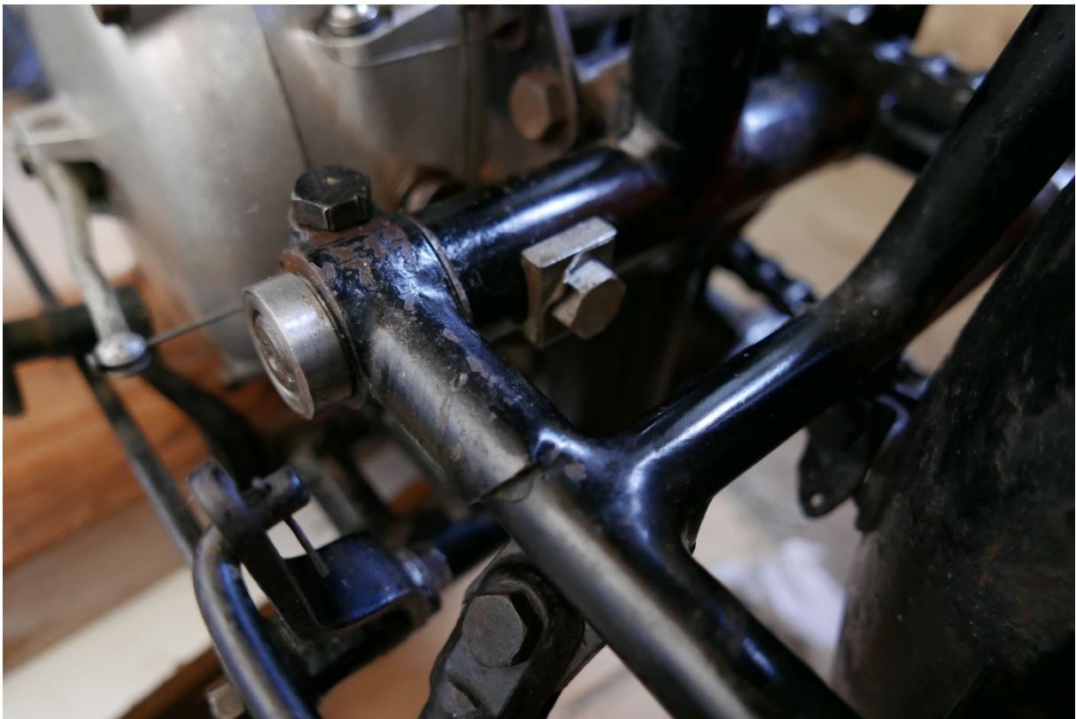
Einde en de oplossing voor het vernieuwen van de bussen in de achterbrug van het model type XIII.
