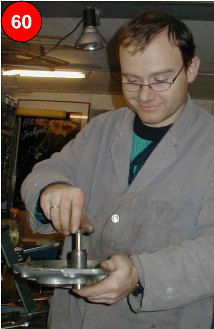
Nockenwellengleitlager im Deckel abziehen
