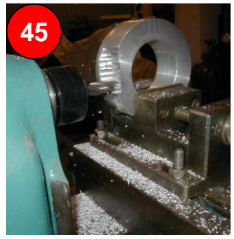
Nutmitnehmer mit der oberen Nutmutter gegen das Wegrutschen sichern
