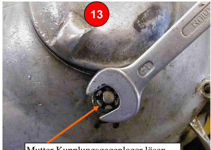
Mutter Kupplungsgegenlager lösen
