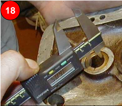
18 Kontrolle Gleitlager im Seitendeckel (max Spiel 0,05- 0,1mm)
