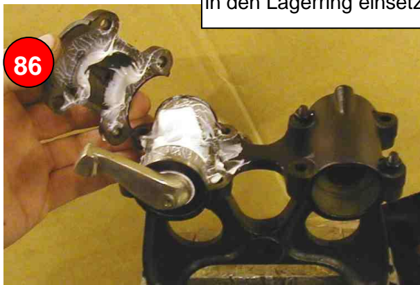
Kipphebel einfetten und Gehäuse zusammenbauen; Schrauben mit 14 Nm anziehen
