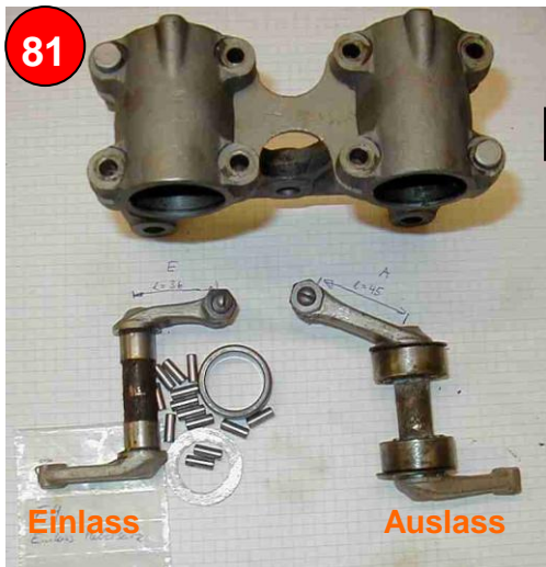
Kipphebelfläche am Ventil abziehen
