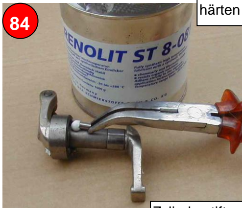
Zylinderstifte mit hitzebeständigem Fett (bis 280°C) (hier Renolit ST 8-08 Fa. Fuchs Lubritec Mannheim) in den Lagerring einsetzen
