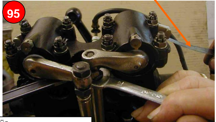
Stößel an den Enden einfetten und einsetzen
