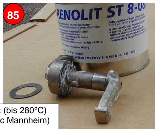
Kontrolle Lagerung Kipphebel: Hier Verschleiß (Kerben) am Einlassventil => neuer Ring (Material 42CrMo4) drehen, härten und schleifen lassen
