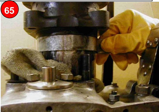
Kolbenringe mit Blech zusammendrücken, Gehohnter Zylinder vorsichtig überstülpen
