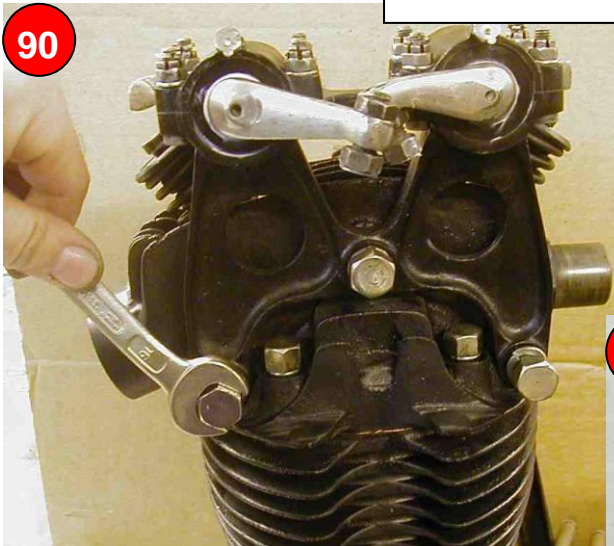
Kipphebel zusammenbauen und anschrauben. Schrauben (M8) mit 28Nm anziehen
