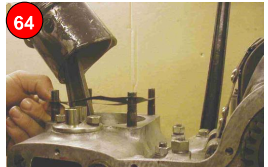
Zylinderfuß: Papierdichtung (Stärke 0,3mm) trocken einlegen, Zylinder aufstecken
