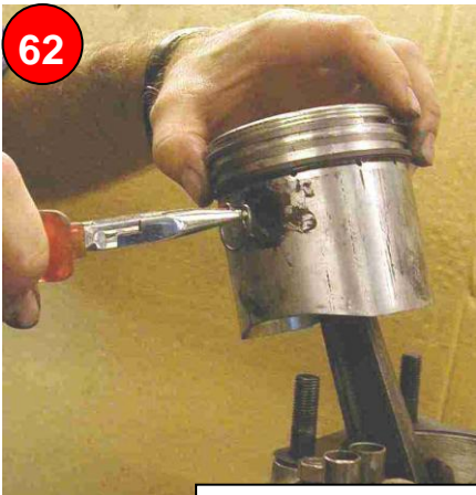
Kolbenbolzen montieren, Sicherungsring einbauen
