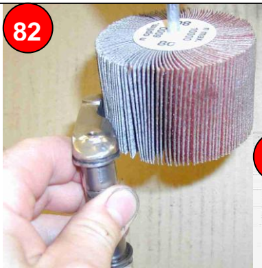
Kipphebelfläche am Ventil abziehen
