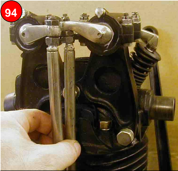
Stößel an den Enden einfetten und einsetzen
