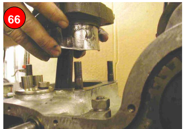
Zylinderfuß: Papierdichtung (Stärke 0,3mm) trocken einlegen, Zylinder aufstecken
