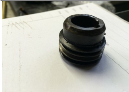
Hinterschneidung des Schneckenrades der Ölpumpe eindrehen, damit dieses besser abgezogen werden kann
