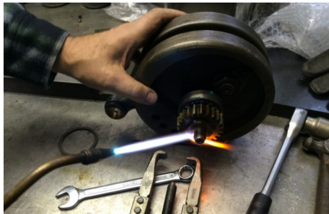
Antriebs-Zahnrad entfernen (max 250°C wegen Schraubensicherung)
